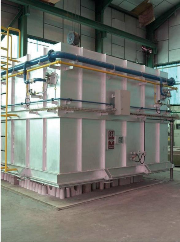
Para el tratamiento térmico de los aceros se requieren temperaturas de 900°C aproximadamente, mantenimiento a temperatura y enfriamiento en el exterior a temperatura ambiente.
